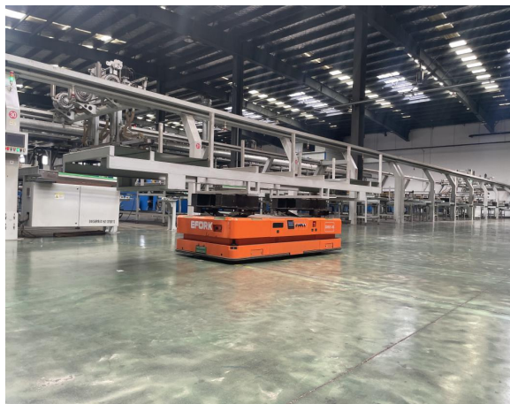
木塑公司车间内，AGV 小车正在有序运输型材
